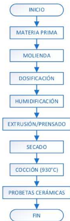
Figura 2. Diagrama de flujo del proceso de preparación de probetas
