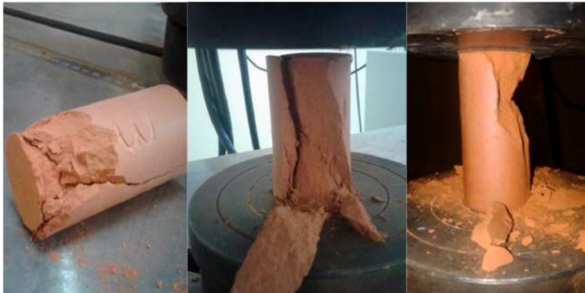
Figura 4. Esquema del mecanismo de fractura Hertziana observado en los ensayos
